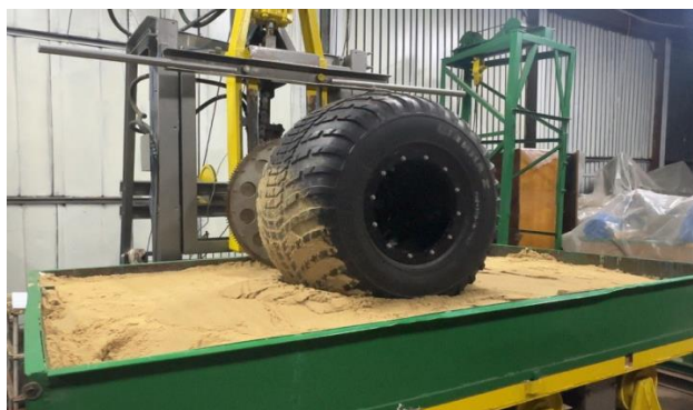
Рисунок 6 – Качение колеса с буксованием
