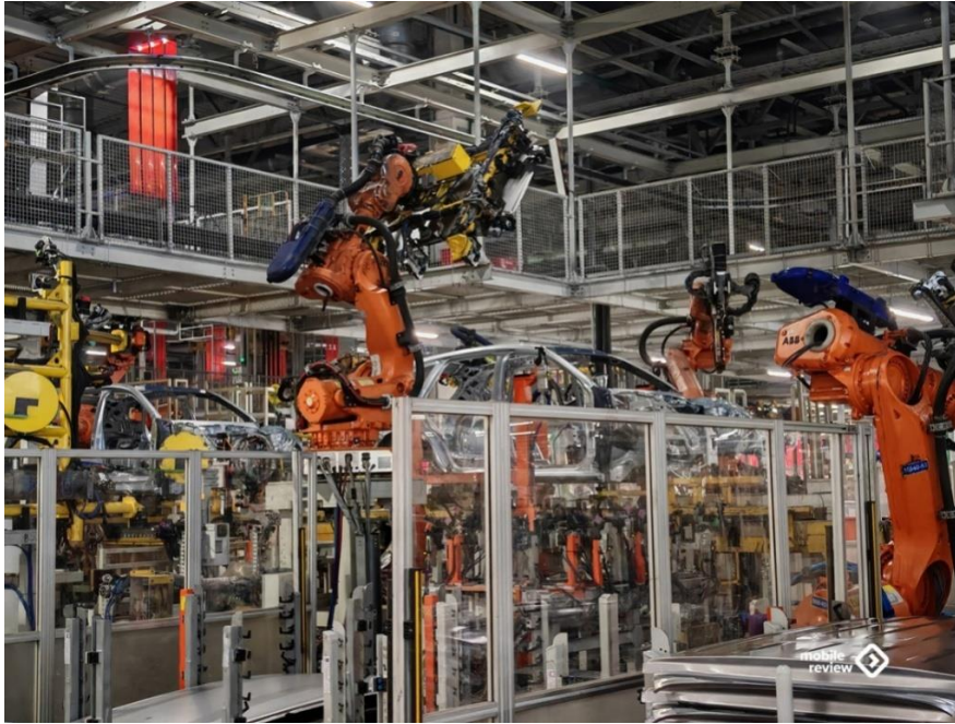
Рисунок 2 – Роботизированные комплексы сварки кузова
