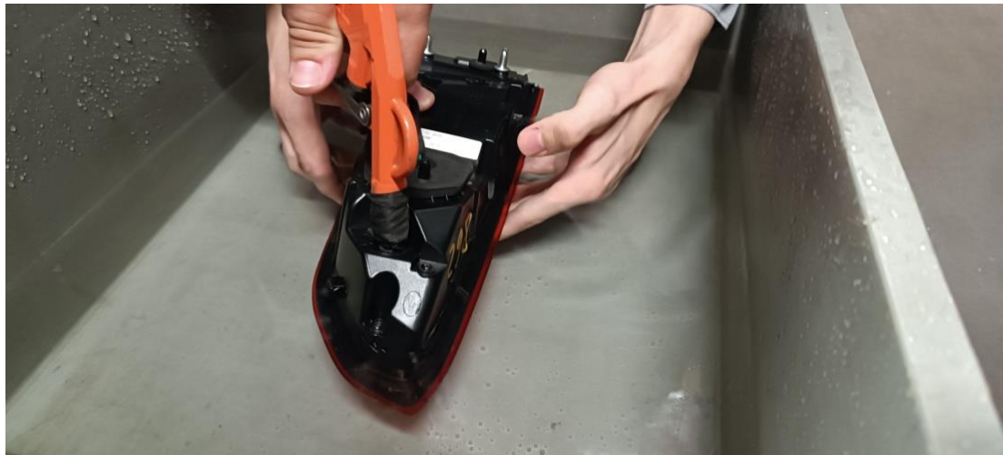
Рисунок 8 – Проверка герметичности фары в ванне
