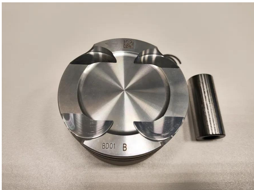
Рисунок 4 – QR-код на поршне автомобиля Haval Dargo
