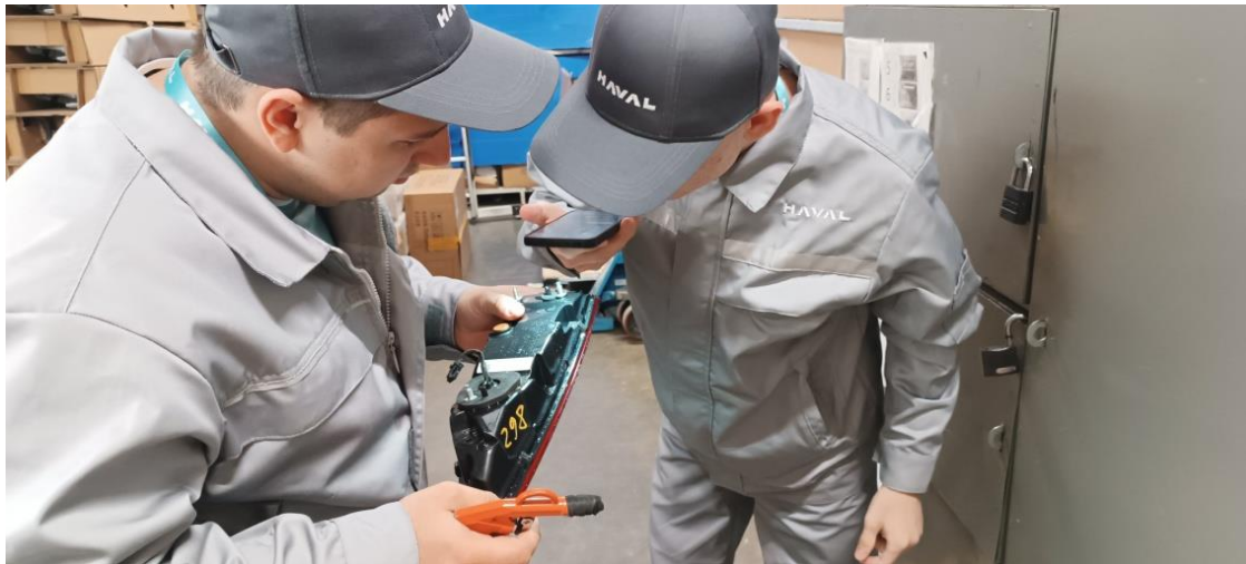
Рисунок 7 – Визуальный осмотр фары
