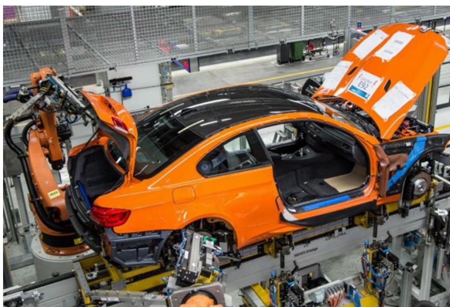
Рисунок 6 – Роботизированная сборка автомобиля на конвейере
