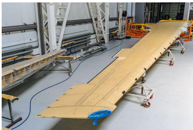
Рис. 2 Часть крыла, изготавливаемая из углепластика
