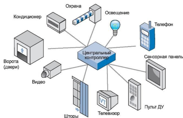
Рисунок 2 – Схема системы «умного дома»
