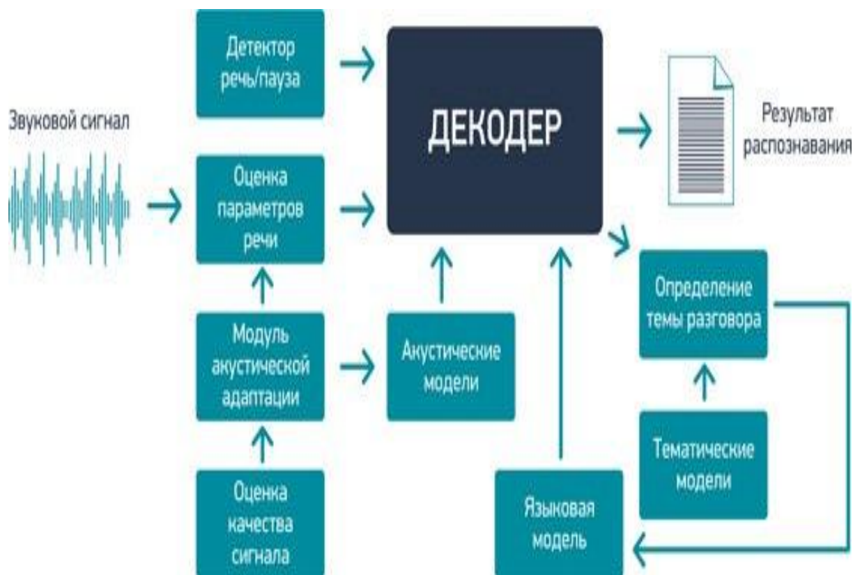
Рисунок 2 – Алгоритм системы ASR
