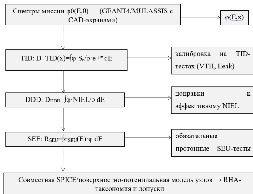
Рисунок 1 – Схема связанного расчёта стойкости КМОП в протонном поле КП
