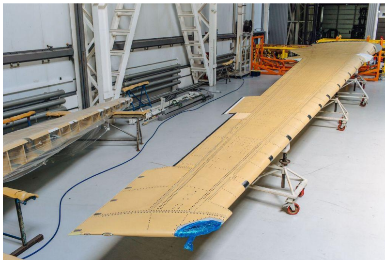
Рис. 2 Часть крыла, изготавливаемая из углепластика
