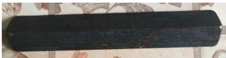
Рисунок 2 – Экспериментальный образец грунтозацепа противобуксовочного устройства
