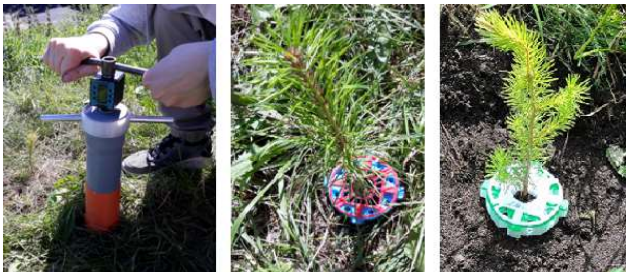
Рисунок 2 – Эксперимент по вкручиванию капсулы в почву: слева – измерение крутящего момента электронным динамометрическим ключом; капсула, закрученная в неподготовленную (в середине) и подготовленную (справа) почву
