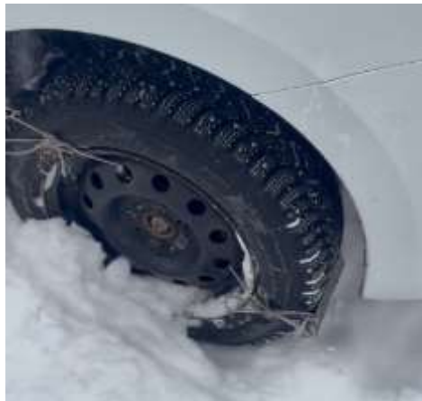
а – пробуксовка колеса без противобуксовочного устройства, б – колесо с противобуксовочными устройствами
