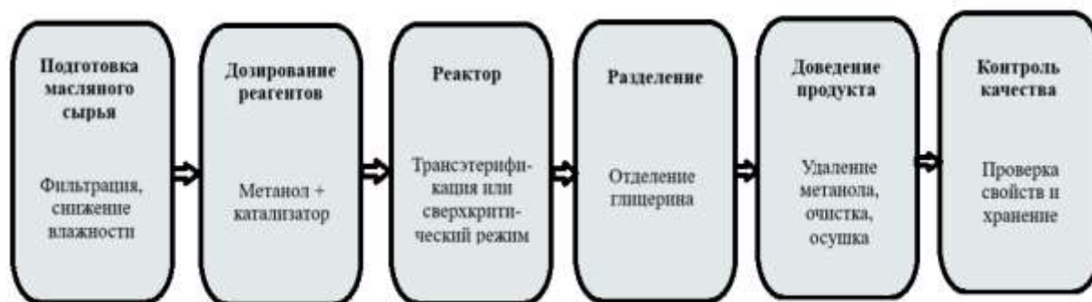
Рисунок 2 – Обобщённая технологическая цепочка получения биодизельного топлива
