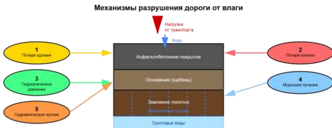
Рисунок 1 – Схема основных механизмов воздействия воды на конструктив автомобильной дороги
