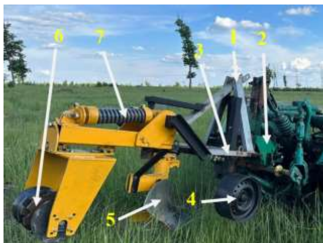
Рисунок 2 – Экспериментальный образец лесного плуга для проведения полевых экспериментов
