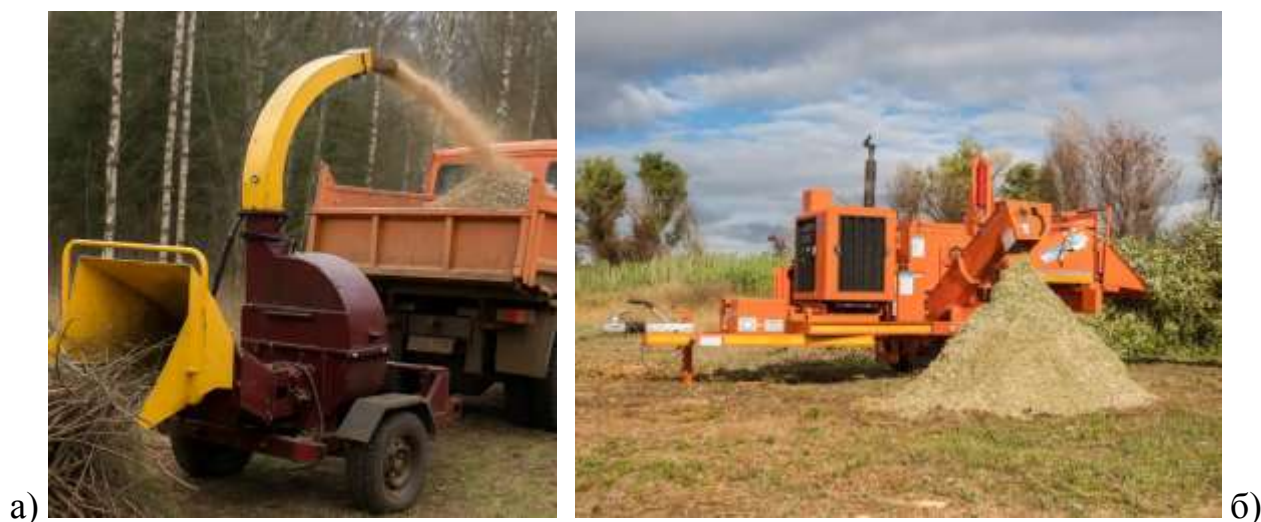
Рисунок 2 – Сформированная щепа из порубочных остатков
