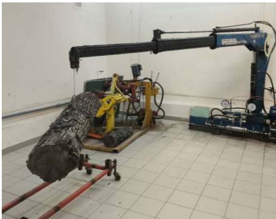
Рисунок 1 – Лабораторная установка на базе серийного гидроманипулятора ЛВ-210-01.
