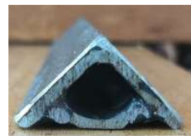
Рисунок 2 – Экспериментальный образец грунтозацепа противобуксовочного устройства
