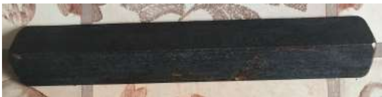
Рисунок 2 – Экспериментальный образец грунтозацепа противобуксовочного устройства
