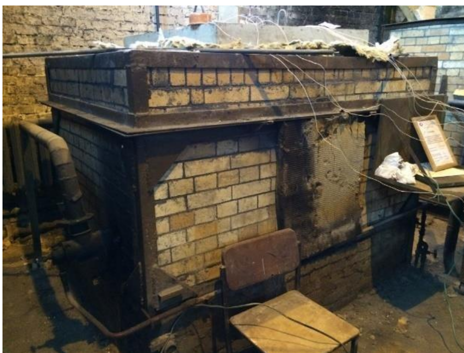
Рис. 5. Малая горизонтальная огневая печь
