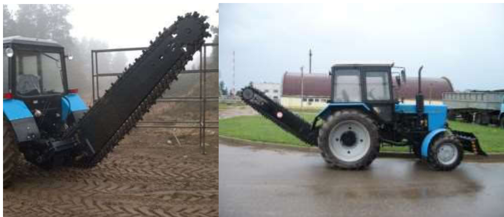
Рисунок 1 – Щеледренажные машины с цепными рабочими органами
