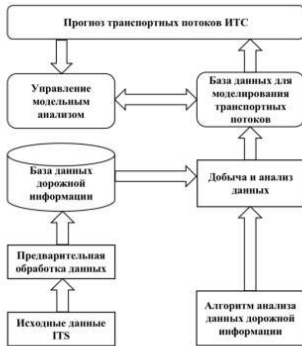
Рисунок 1 – Модель прогнозирования транспортных потоков на основе больших данных
