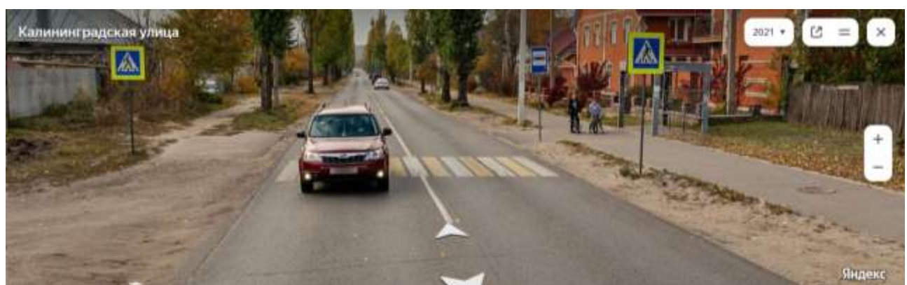
Рисунок 4 – Отсутствие заездных карманов для автобусов на остановке «Старый магазин»
