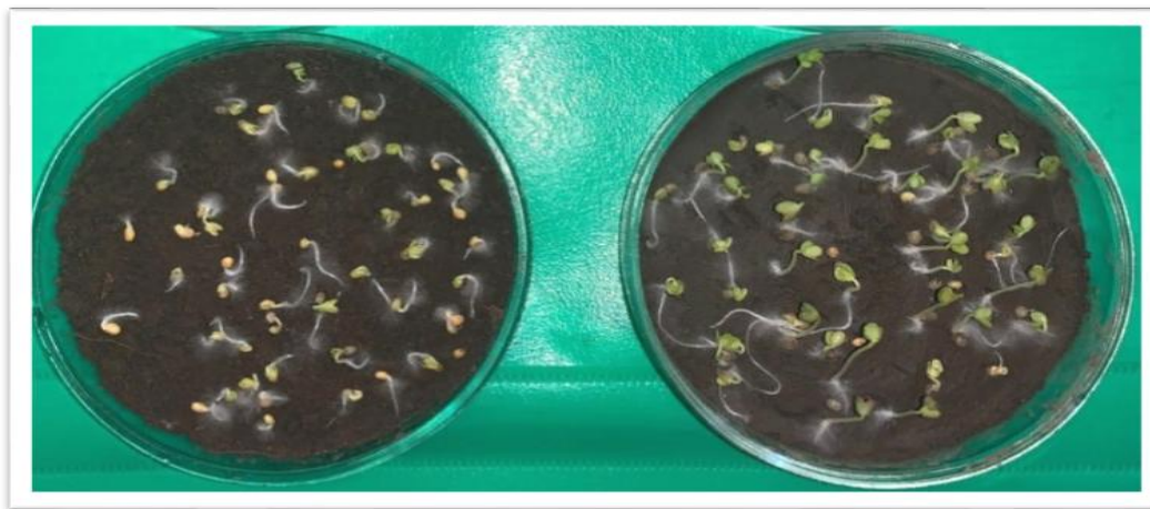
Рисунок 2 – Метод биотестирования на почвенных пластинках; результаты: почвенная проба старый плодовый сад (50 лет) и плодовый сад (4 года) [фото автора]
