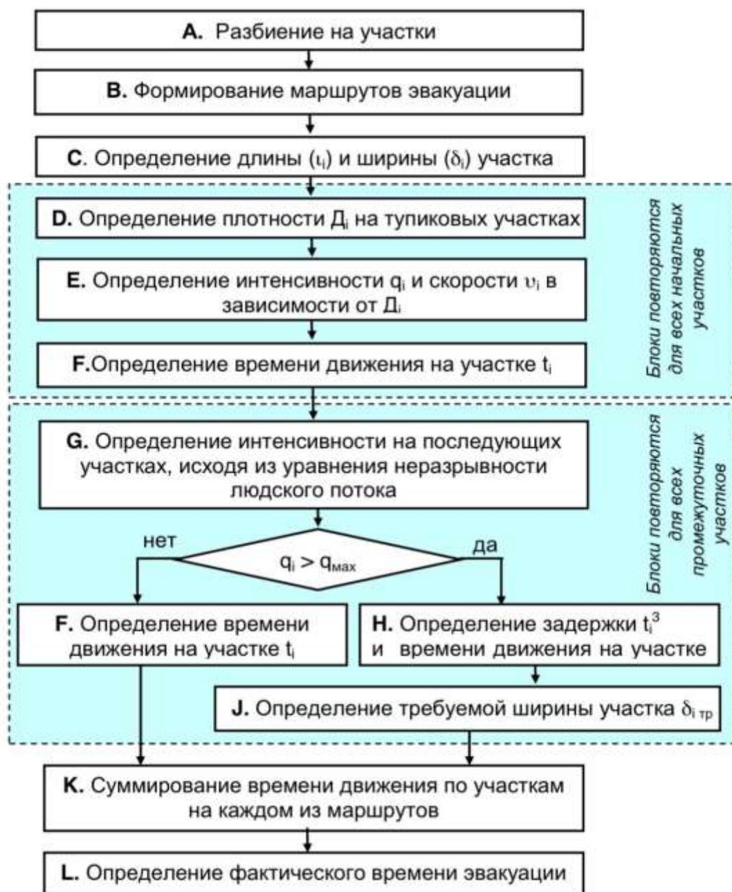
Рисунок 1 – Алгоритм определения расчётного времени эвакуации
