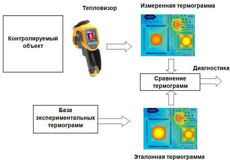
Рисунок 2 – Сравнительная инфракрасная термография
