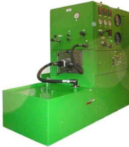
Рисунок 1 – Стенд КИ-4200 для испытания гидроприводов
