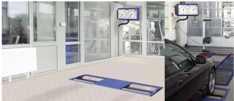
Рисунок 2 – Роликовый тормозной стенд
