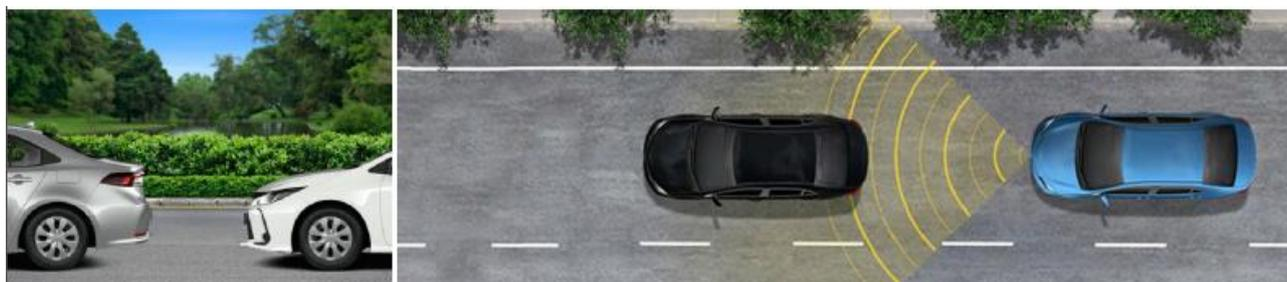
Рисунок 1 – Следование за движущимся впереди автомобилем
