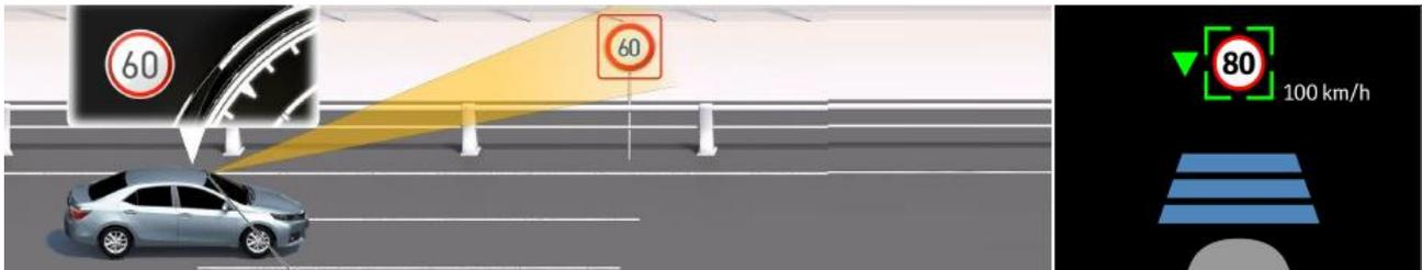
Рисунок 2 – Принцип работы системы RSA
