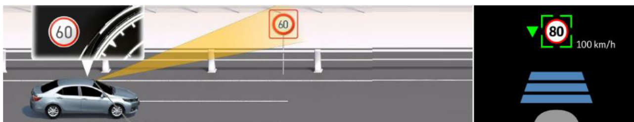
Рисунок 2 – Принцип работы системы RSA
