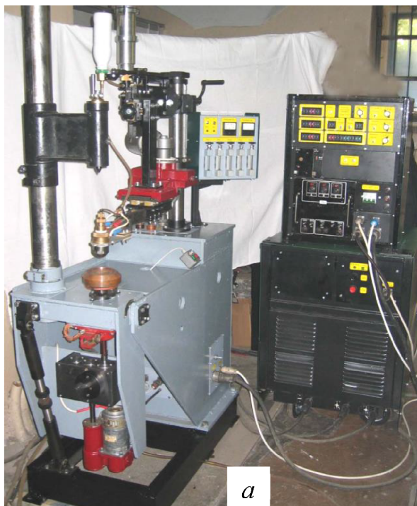
Рисунок 6 – Общий вид (а) и гибридный процесс (б) нанесения покрытия на фаску клапана
