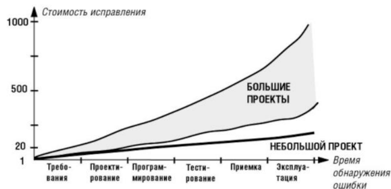
Рисунок 1 - Стоимость исправления – задачи тестирования ПО – снизить стоимость разработки путем раннего обнаружения дефектов; тест дизайн – самая ранняя фаза, на которой тестирование врезается в разработку
