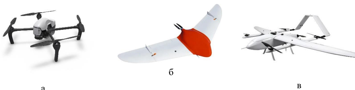
а) мультироторный тип; б) самолетный тип («крыло»); в) VTOL
