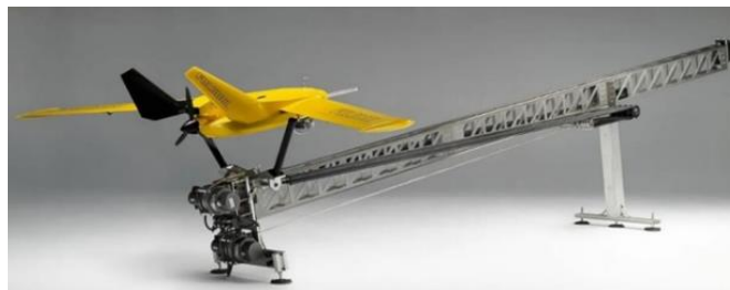
Рисунок 3 – БПЛА, подготовленный к запуску с помощью катапульты
