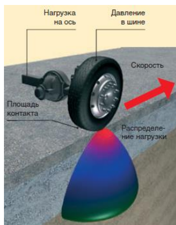
Рисунок 3 - Нагрузки транспорта на дорожную одежду
