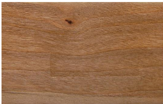
Рисунок 2 - Фото модифицированной древесины ольхи с текстурой полисандра: увеличение 20
