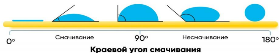
Рисунок 1 – Схемы возможного положения капли на твердой поверхности
