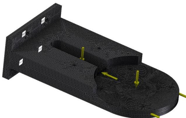
Рисунок 5 – Сгенерированная сетка конечных элементов для детали «Держатель»
