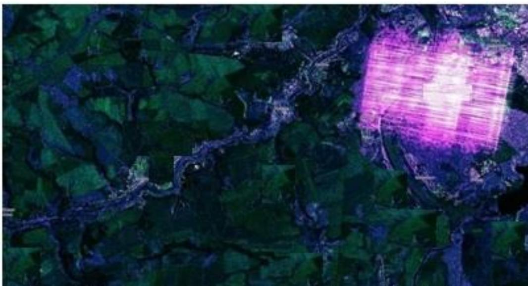
Рисунок 1 – Типичное радиолокационное изображение местности в условиях постановки радиопомех
