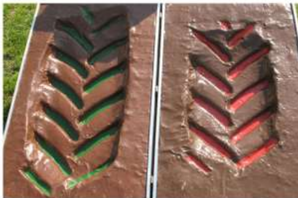
Traktor-Reifen: A) mit niedrigem Druck B) mit hohem Druck
