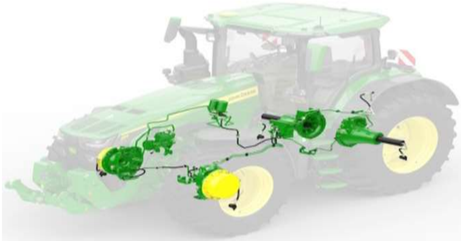
Abbildung 5 – Der John Deere-Traktor der Serie 8R ist mit einer werkseitig automatischen Reifendruckregelung ausgestattet
