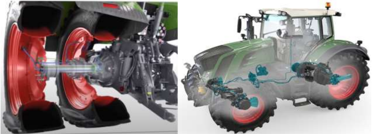
Abbildung 3 – Technische Umsetzung des automatischen Systems Vario Grip Pro Reifendruckregelung
