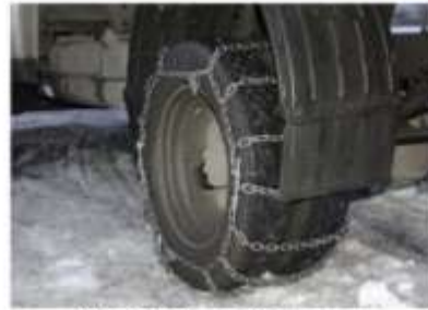
Abnehmbare Ketten an Doppelreifen des Ural-4320
