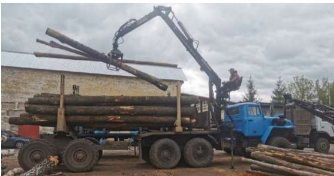
Рисунок 1 – Гидроманипулятор «МАЙМАН-100S» на базе УРАЛ-5557
