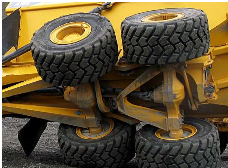
Рисунок 2 – Ведущие мосты сочлененной машины
