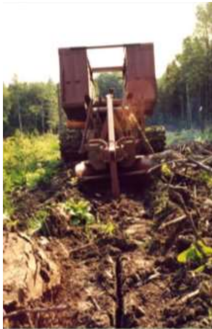
Рисунок 1 – Плуг-рыхлитель лесной ПРЛ-70
