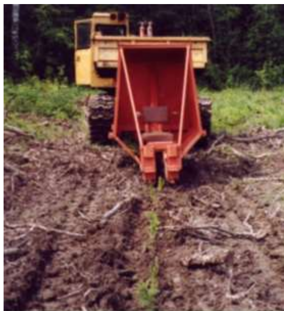
Рисунок 2 – Машина лесопосадочная для крупномера МПС-1
