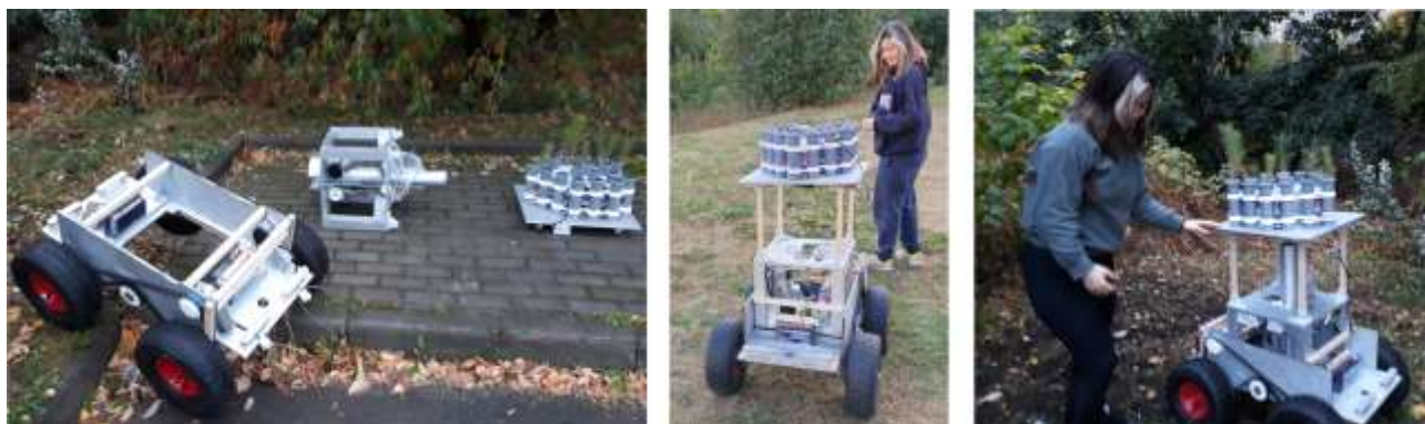
Рисунок 2 – Испытания полноразмерного прототипа посадочной машины
