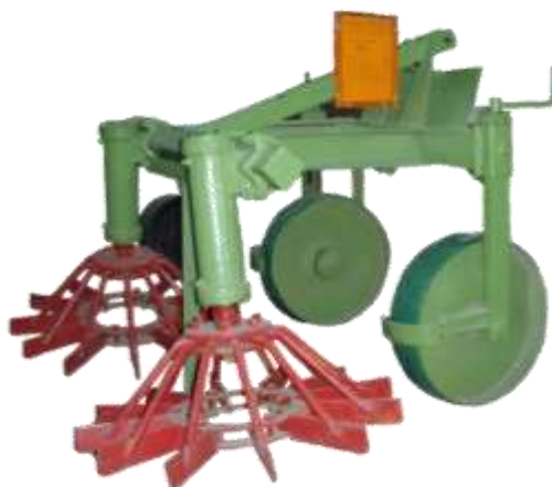
Рисунок 1 – Культиватор ротационный лесной КРЛ-1А
