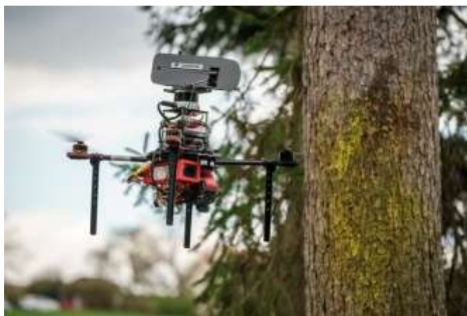
Рисунок 3 – Модульный дрон Т650 для обнаружения короеда с распылительным механизмом для маркировки зараженного дерева
