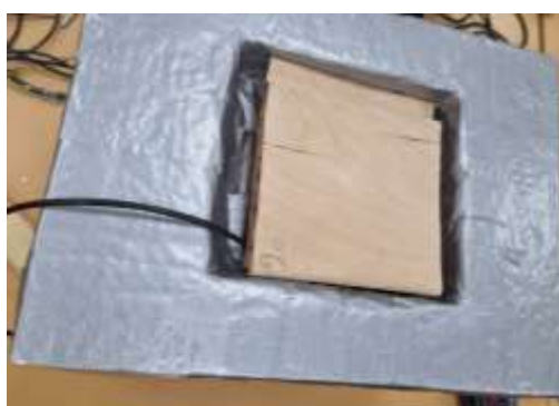
Рисунок 2 – Расположение образца при испытании, изоляция снята.
