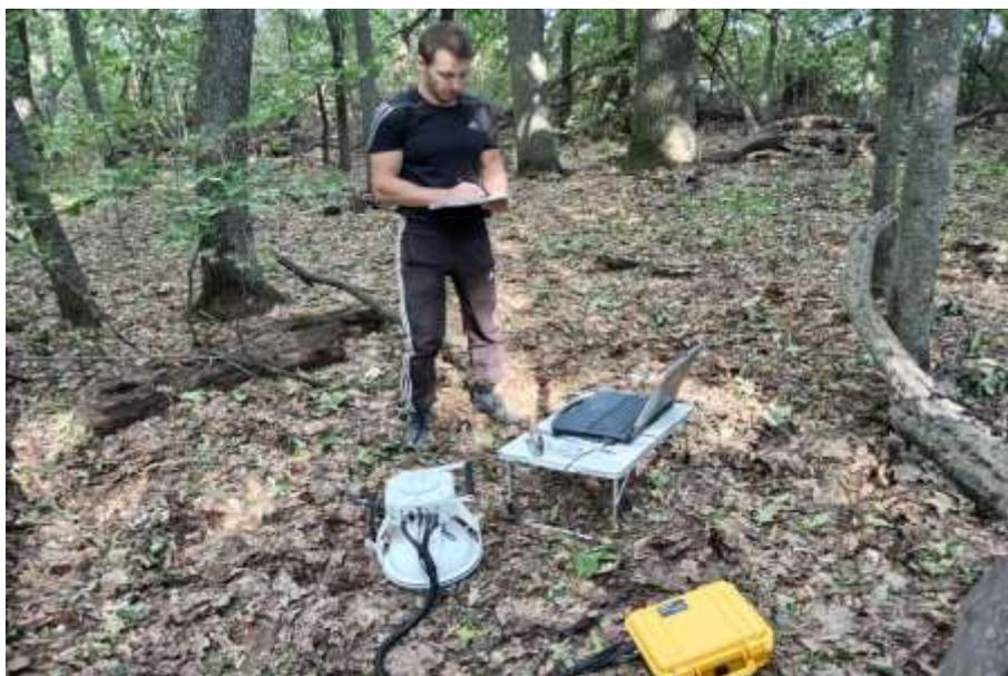
Рисунок 1 – Измерение потока углекислого газа на участке полевой защитной лесополосы
