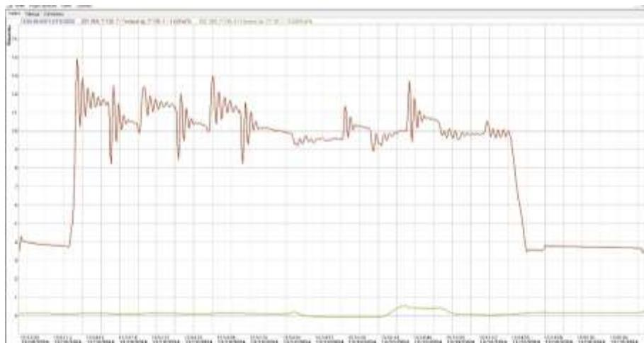
Рисунок 9. Экспериментальные осциллограммы давления рабочей жидкости в гидроцилиндре подъема стрелы без подключения демпфера
