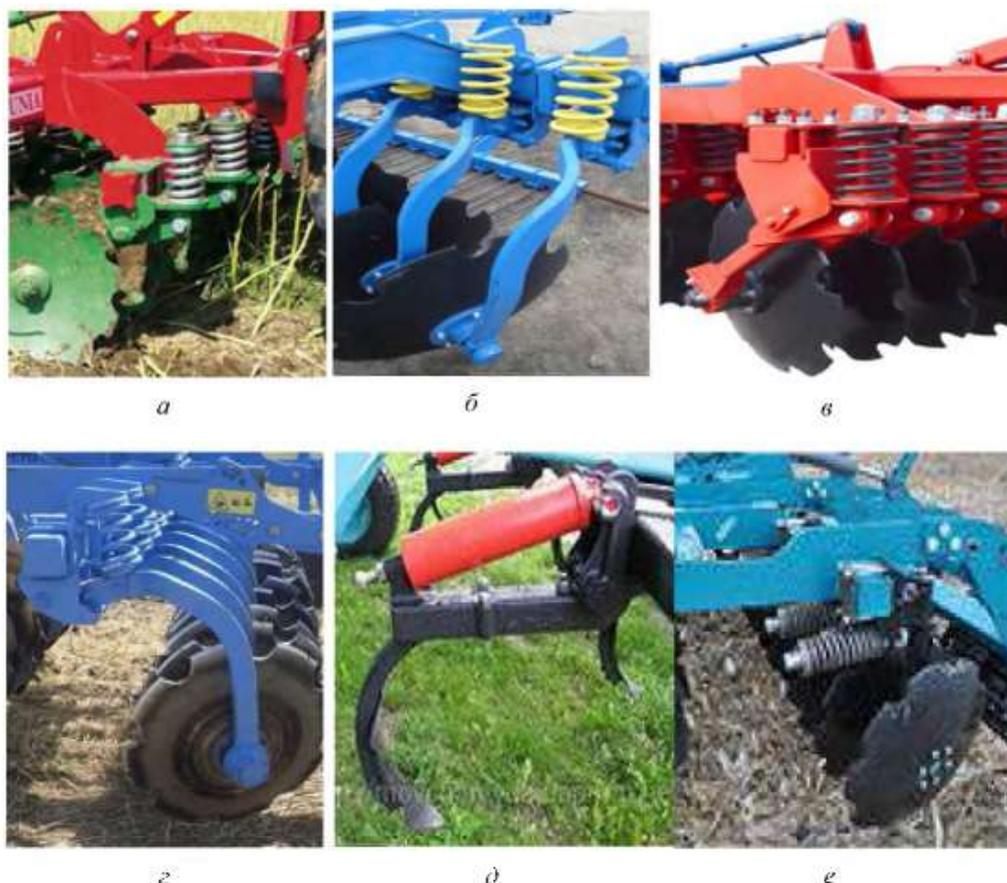
Рисунок 1 – Пружинно-гидравлические предохранители рабочих органов дисковых орудий: а - навесного почвообрабатывающего агрегата ARES TWIX; б - полунавесного дискатора АГЛ-4; в - прицепной бороны БДТ-2,5\*2; г - полунавесной бороны АГЛ-6; д - бороны с чизельной приставкой БДВП-4,2-0,1; е - мульчирующей бороны «Вектор» В-350»
