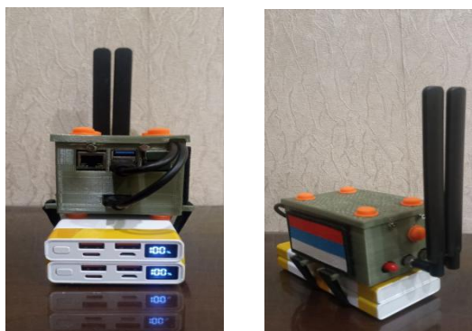
Рисунок 7 – Внешний вид готового программно-аппаратного модуля мониторинга каналов управления и передачи данных БПЛА «ДJI»
