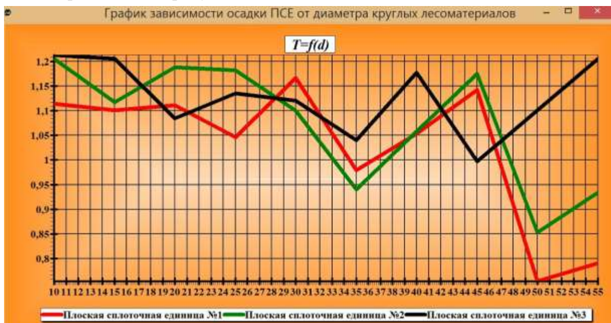
Рисунок 4 – Графики зависимости осадки плоских сплотовых единиц от диаметра круглых лесоматериалов в верхнем отрезе
