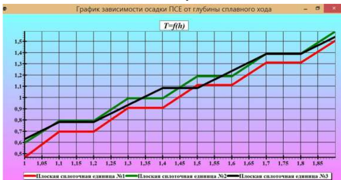
Рисунок 3 – Графики зависимости осадки плоских сплоточных единиц от глубины сплавного хода
