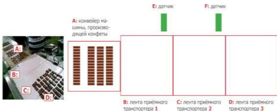
Рисунок 1 – Приёмный транспортёр, состоящий из трёх сегментов
