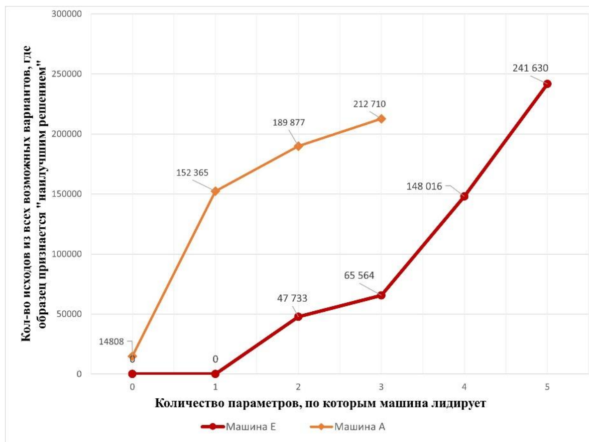
Рисунок 2 – результаты проведения расчетов путем применения алгоритма оценки технического уровня НТТС с учетом последовательного изменения нескольких параметров машины
