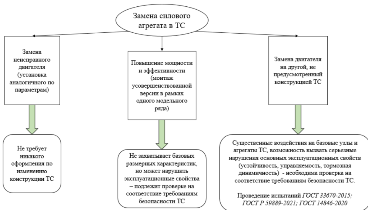
Рисунок 1 – Описание причин замены силового агрегата
