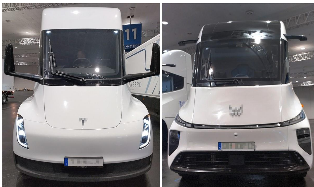
Рисунок 1 – электрические грузовики с кабинами пониженного аэродинамического сопротивления
