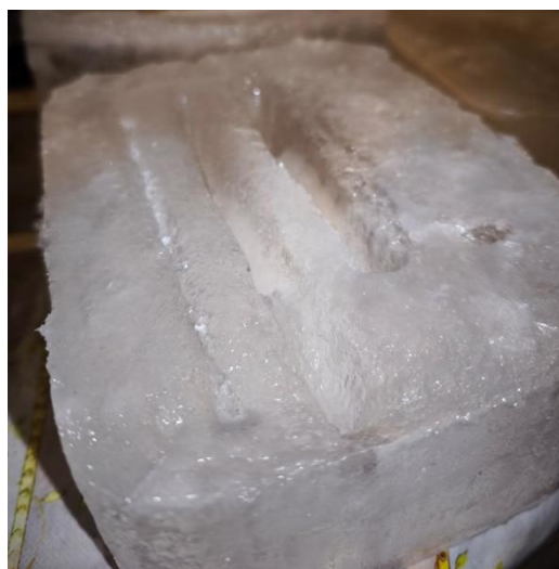
Рисунок 3 – Образец льда после резания
