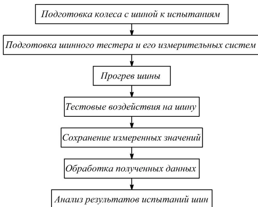
Рисунок 1 – Алгоритм методики испытания шины в режиме торможения
