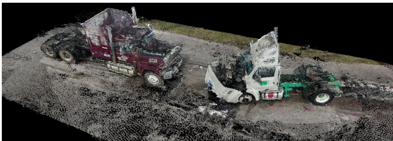
Рисунок 4 – Пример сканирования при помощи технологии Lidar, с наложением на цифровую модель фотоснимков, изготовленных при помощи БПЛА.
