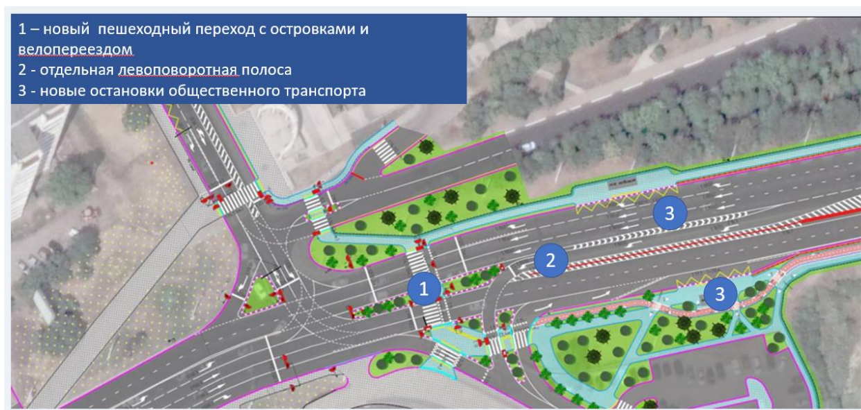
Рисунок 4 – схема организации дорожного движения на перекрестке
