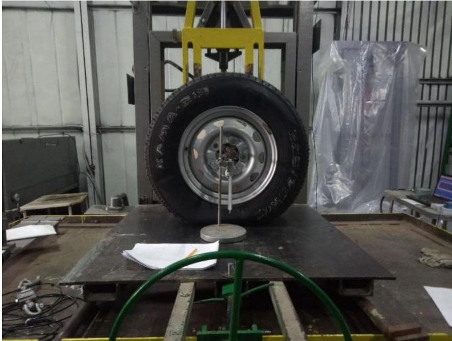
Рисунок 4 – Шина Кама-219 на стенде СИХШ 2500-1000
