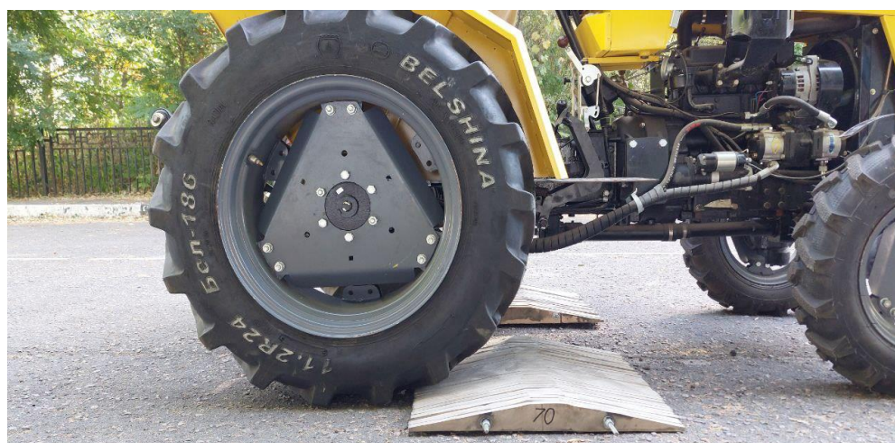
Рисунок 7 – Установка и размещение искусственных неровностей высотой 70 мм перед задней осью мини-трактора
