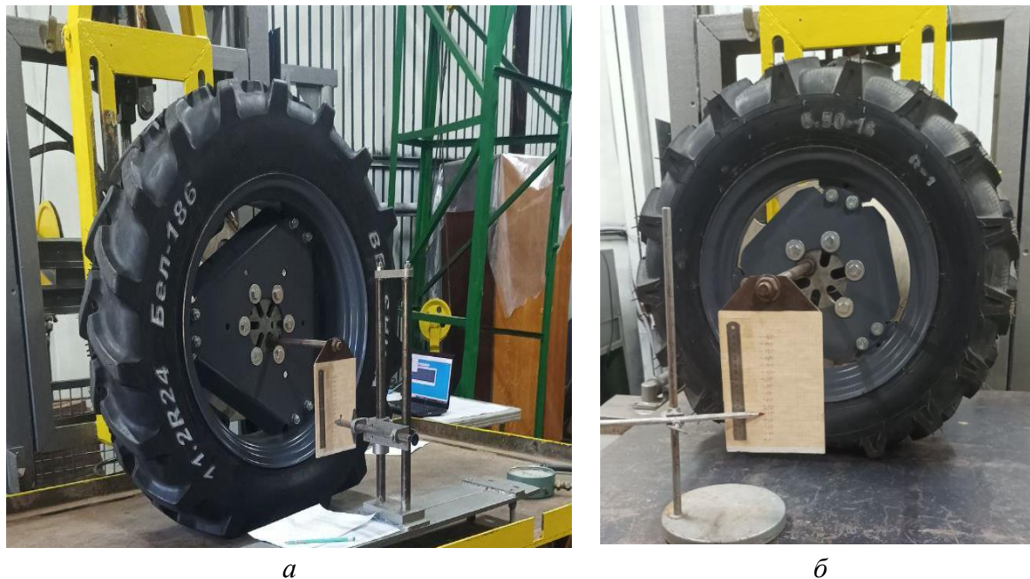
Рисунок 4 – Испытания шин на тангенциальную деформацию а – Шина Бел-186; б – Шина 6.50-16 R-1
