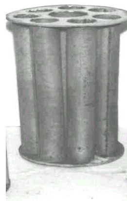
Рисунок 7 – Фильтрующий элементы из ПНС –6 трубчатого типа после исследований
