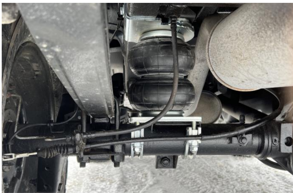
Рисунок 2 – Задняя подвеска автомобиля УАЗ с применением пневмобаллона
