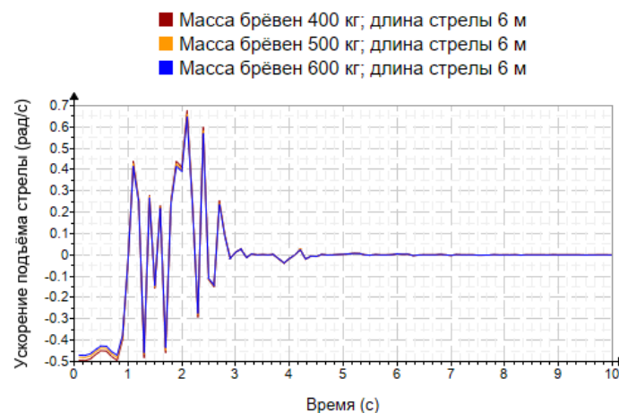
Рисунок 3 – Графики зависимости ускорения подъёма стрелы от времени при различных значениях массы брёвен
