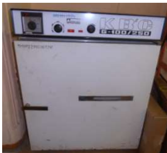
Рисунок 7 – Оборудование, применяемое для определения влажности щепы
