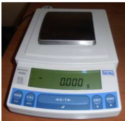
Рисунок 7 – Оборудование, применяемое для определения влажности щепы
