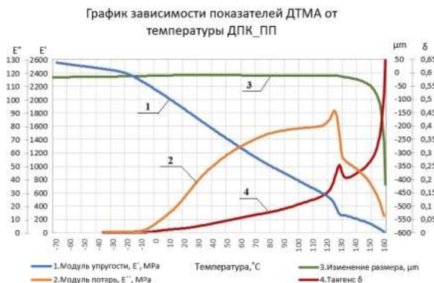
Рисунок 2 – Результаты по динамическому термомеханическому анализу древесно-полипропиленового композита
