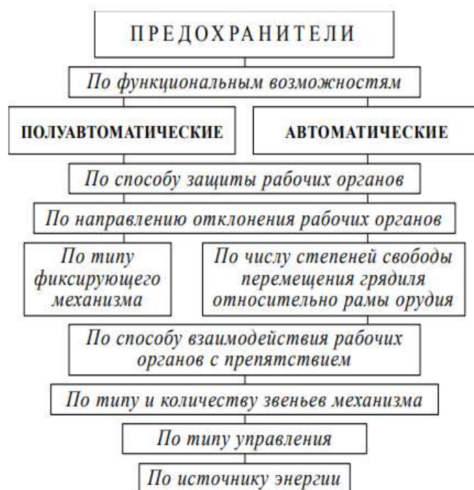
Рисунок 3 – Виды предохранителей по функциональным возможностям
