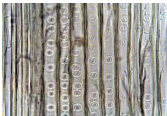
Рисунок 2 – Микроснимок радиального среза исследуемого образца древесины. Поровость осевых трахеид. Препарат не окрашен.
