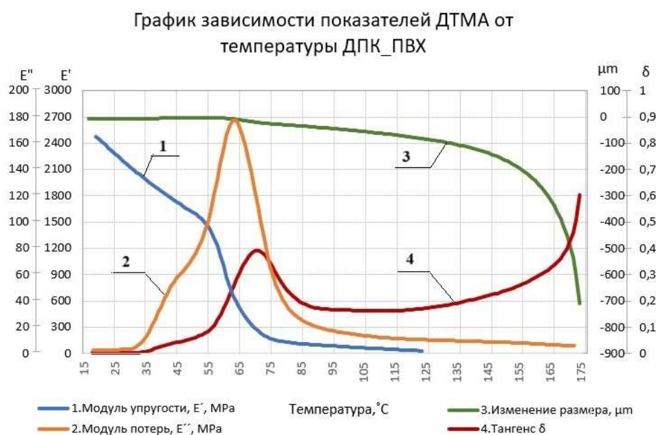
Рисунок 2 – Результаты по динамическому термомеханическому анализу древесно-поливинилхлоридного композита.
