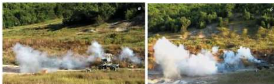
Рисунок 2 – Распыление порошка выстрелом пожаротушащего снаряда
