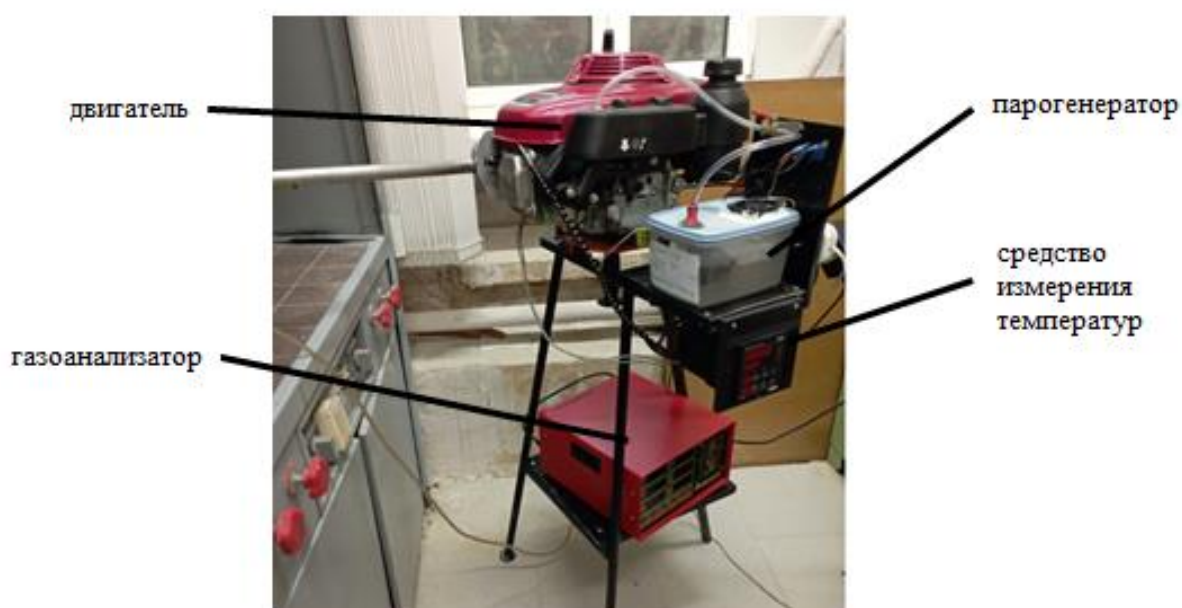
Рисунок 3 – Экспериментальная установка для исследования эффективности работы поршневого двигателя при использовании смеси топлива и водяного пара Figure 3 – Experimental setup for studying the efficiency of a piston engine using a mixture of fuel and water vapor
