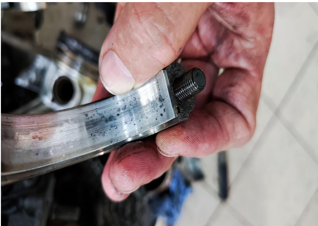
Рисунок 1 – Следы попадания посторонних частиц на подшипнике скольжения Illustration 1 – Traces of foreign particles on the plain bearing
