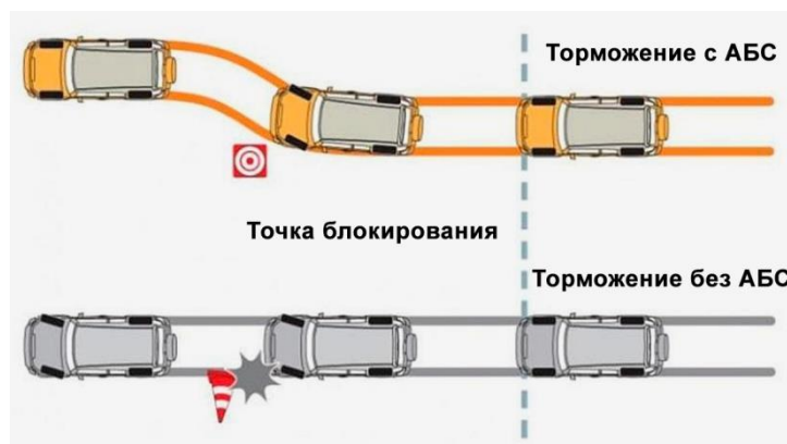
Рисунок 3 – Принцип работы системы ABS
