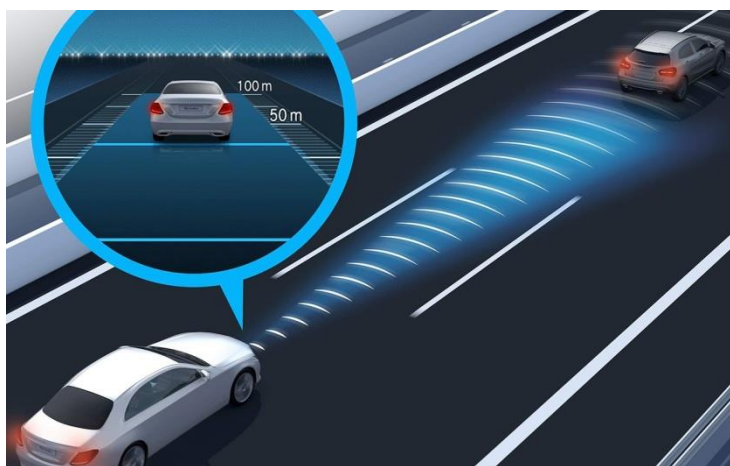
Рисунок 9 – Адаптивный круиз-контроль АСС
