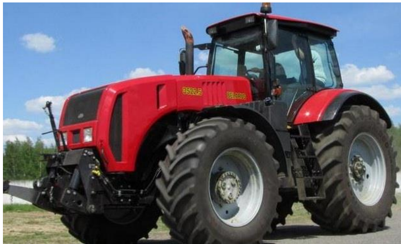
Рисунок 2 – Трактор «Беларус-3023» с электромеханической трансмиссией
