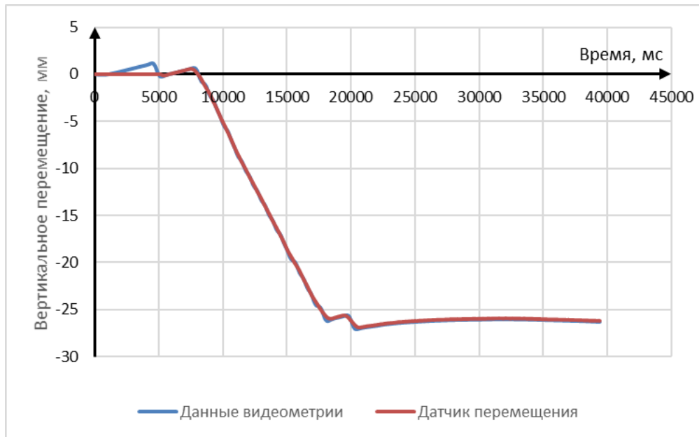
Рисунок 7 – Зависимость вертикального перемещения реперной точки от времени опыта при вертикальной обжимке шины
