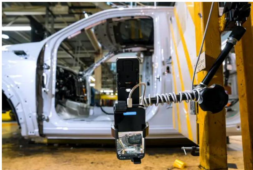
Рисунок 10 – Применение компьютерного зрения компанией Ford для определения дефектов
