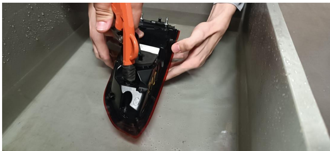
Рисунок 8 – Проверка герметичности фары в ванне
