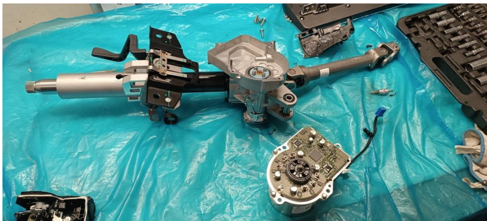
Рисунок 9 – Разборка электроусилителя и поиск неисправности
