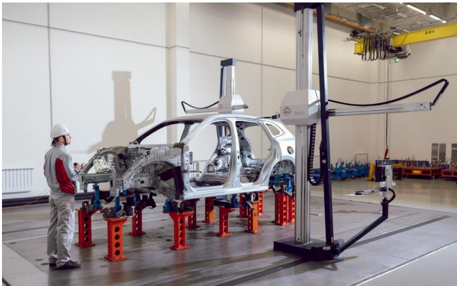
Рисунок – 1 Роботизированная установка для замера сварочных деталей кузова на заводе Naval
