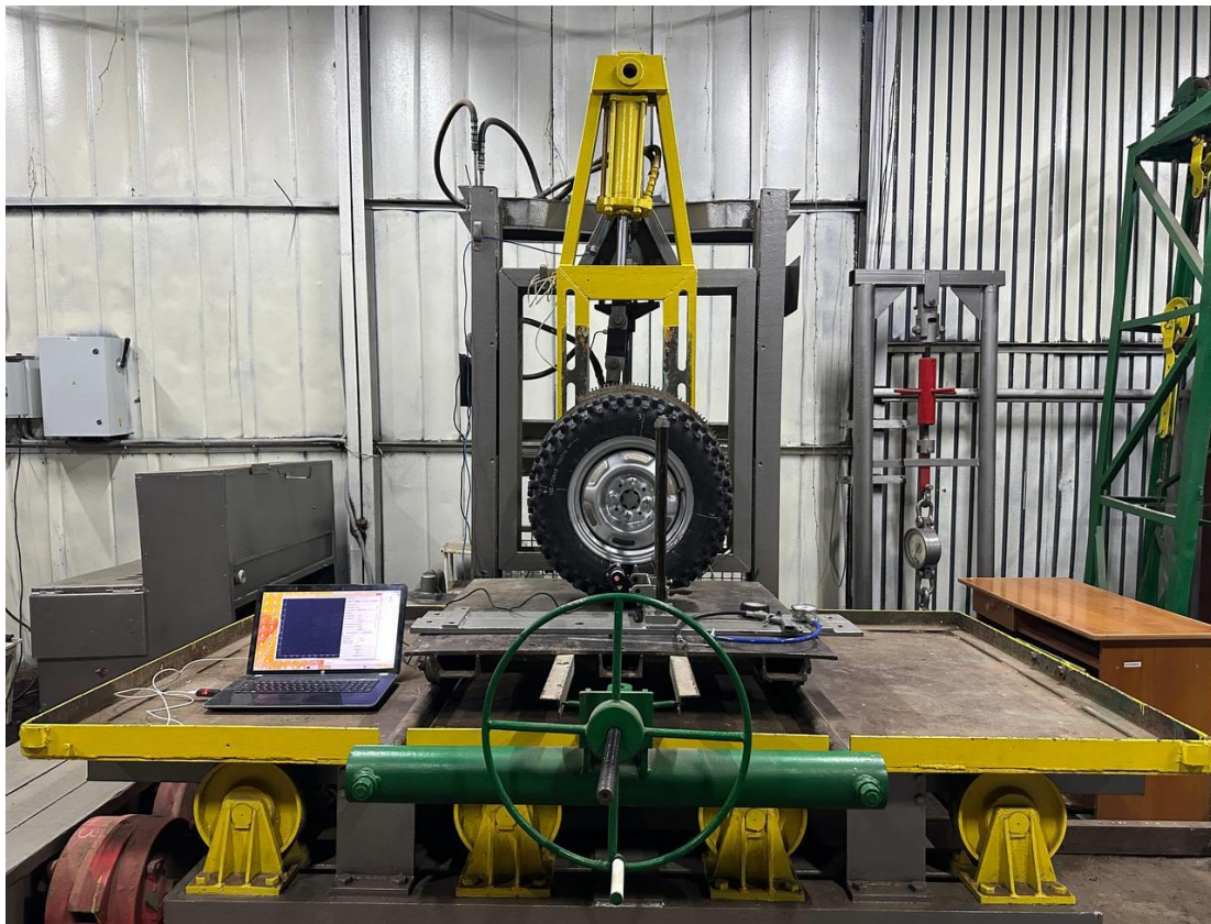
Рисунок 5 – Определение нагрузочной характеристики шины модели НК-11 размерностью 185/70 R13
