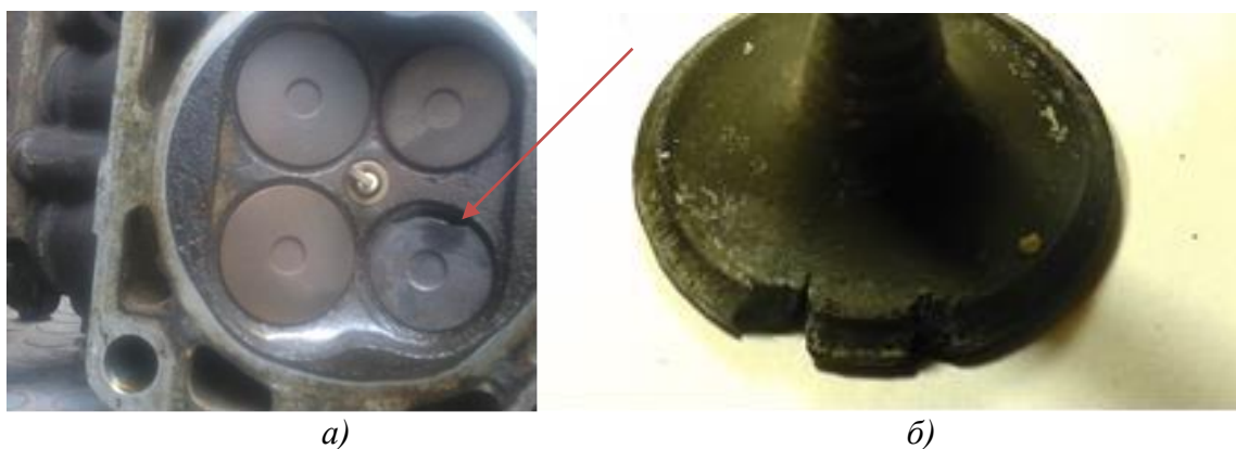
а ) – общий вид; б ) – вид клапана, вышедшего из строя
