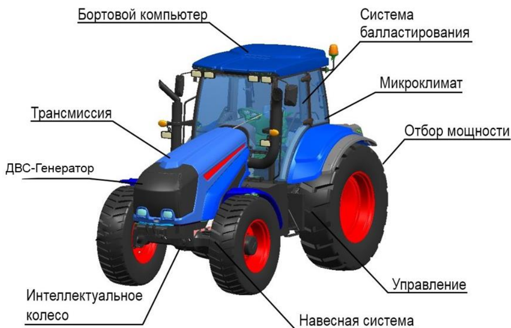
Рисунок 4 – Трактор класса 2 с гибридной трансмиссией
