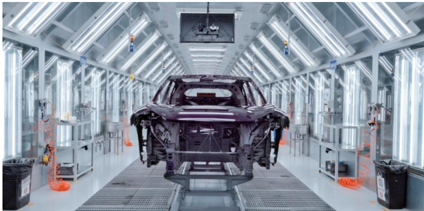
Рисунок 9 – Применение компьютерного зрения для определения качества покраски в световом тоннеле
