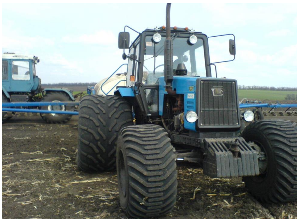
Рисунок 1 – Колёсный трактор МТЗ-1221 на широкопрофильных шинах низкого давления
