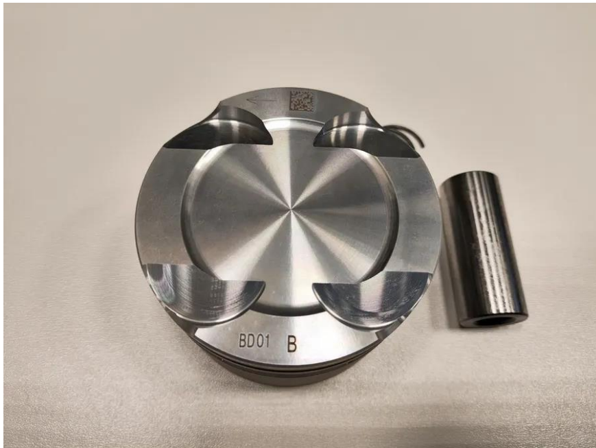
Рисунок 4 – QR-код на поршне автомобиля Haval Dargo
