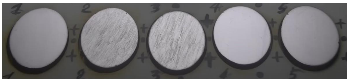
Рисунок 8 – Этап II: толщина пленки 10...20 мкм, время ожидания 30 минут
