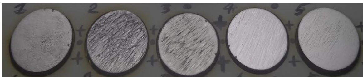
Рисунок 7 – Этап I: толщина пленки 20...40 мкм, время ожидания 30 минут
