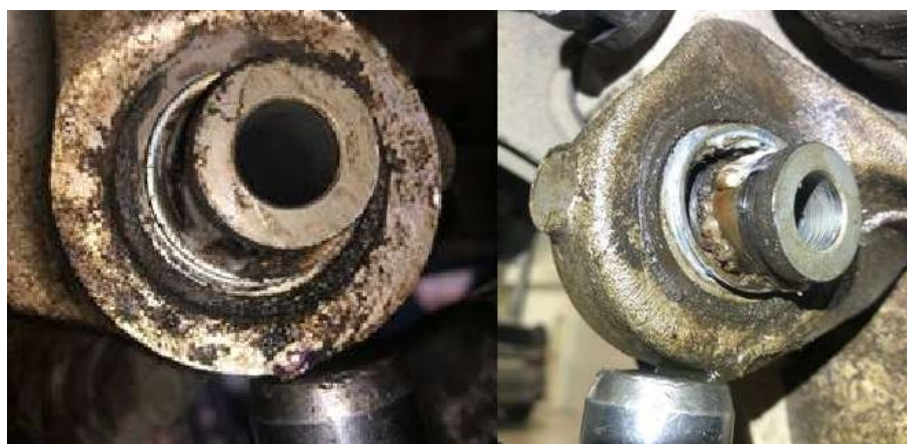
Рисунок 4 – Коррозия и вода в плавающем шарнире
