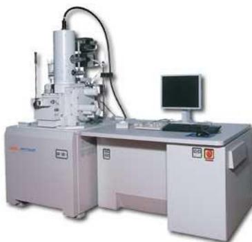
Рисунок 2 – Сканирующий (растровый) электронный микроскоп JEOL JSM-7600
